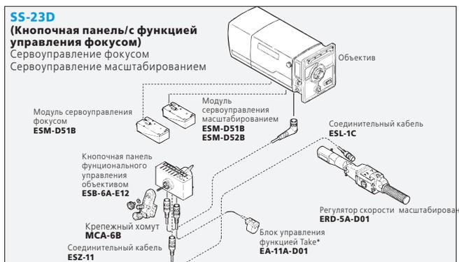
\*Функция Take служит для привязки определенной установки масштабирования и фокуса к конкретной кнопке.
